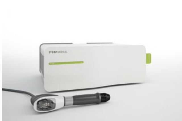
Modulo R-SW con display sull'applicatore e sensore »Skin Touch«
